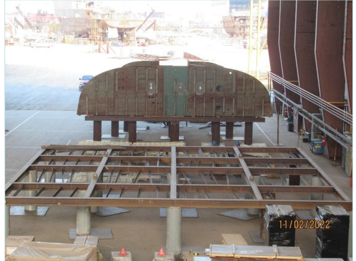
Module 22 inner bottom
